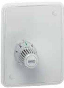
Uređaj koji kontroliše temperaturu u prostoriji reguliše protok medija kroz jedan podni grejni krug, bez dodatnih grejača, u zavisnosti od temperature ambijenta. Uređaj se može montirati i na napajanju i na povratku podnog grejnog kruga. Termostat prima temperaturu ambijenta i propisno reguliše protok vode u grejnom krugu.
