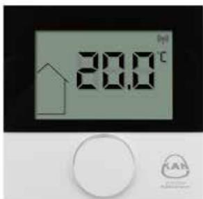
Bežični sobni termostat sa LCD zaslonom je uređaj koji kontroliše KAN-therm Smart električni terminalni blok (24V ili 230V) preko radio talasa. Koristi se za prikazivanje temperature u prostoriji i za podešavanje željene temperature u određenoj grejnoj zoni.
