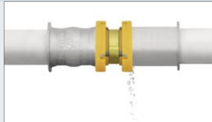
2 Niezaprasowane połączenie sygnalizowane jest wyciekiem wody już w stanie bezciśnieniowym
